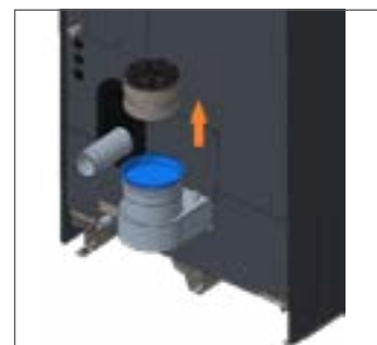
Fig. 13. Rimozione della griglia di aspirazione aria dal suo alloggiamento usato per il trasporto
