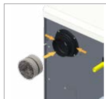
Fig. 14. Installazione della griglia di aspirazione dell'aria
